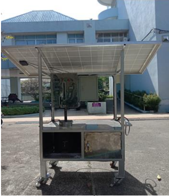
ภาพที่ 1 เครื่องขึ้นรูปภาชนะจากวัสดุธรรมชาติโดยใช้พลังงานหมุนเวียน
