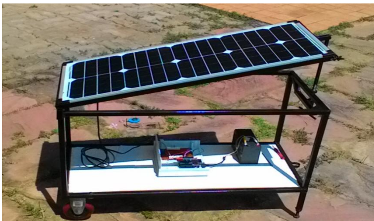
รูปที่ 2 แสดงต้นแบบเครื่องบันทึกค่าแสงอาทิตย์โดยใช้ไมโครคอนโทรลเลอร์อาร์ดุยโน
