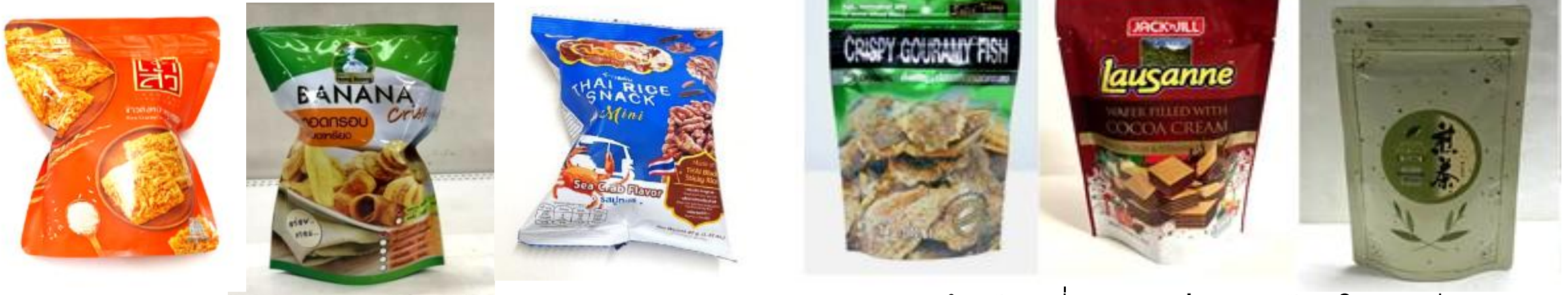
การอัดก๊าซมากเกินไปจนถุงป่อง เสียรูป
